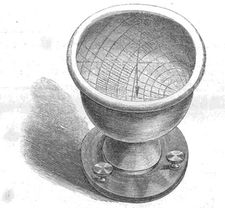
Die Parallelkreise werden rechtwinklig von einer Anzahl großer Kreise durchschnitten, welche die Tagesstunden bezeichnen. Kleinere Kreisbogen bezeichnen die Viertelstunden und die Punkte zwischen letzteren Zeitabschnitte von 5 zu 5 Minuten.
